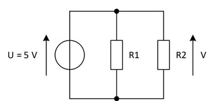
**Q5.** Calculer  $V_s$  dans le montage suivant :
