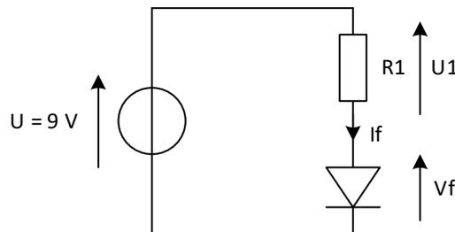
Pour éviter de « griller » la DEL (tension et courant trop élevés), il est indispensable de mettre en série une résistance dont la valeur permettra de limiter la tension et le courant de la DEL.
