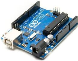
Les cartes Arduino sont conçues pour réaliser des prototypes et des maquettes de cartes électroniques pour l’informatique embarquée.
