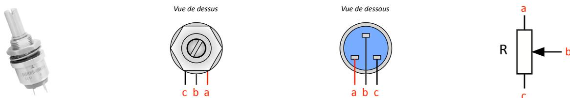
Le potentiomètre mis à votre disposition est un potentiomètre rotatif de précision. Sa résistance est indiquée sur son boîtier.
