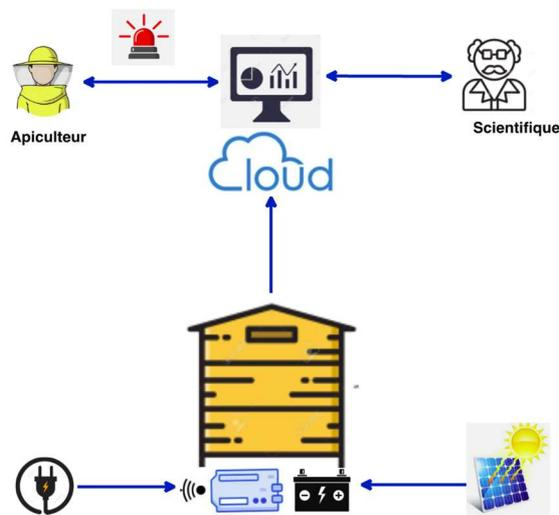
Les informations collectées par les capteurs doivent être stockées et transmises au scientifique et à l'apiculteur pour étude et analyse.
