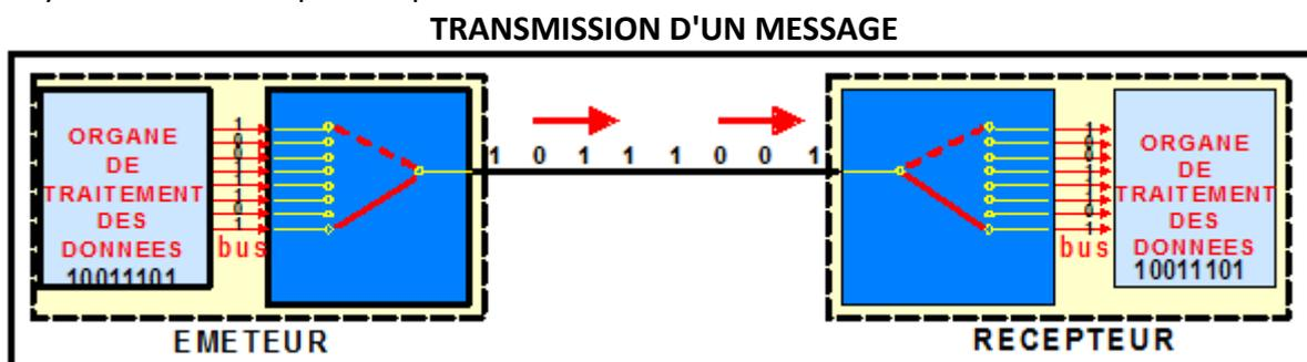
REMARQUE : sur une liaison série synchrone, le signal d'horloge permettant la synchronisation de l'émetteur avec le récepteur est transmis avec les données.
