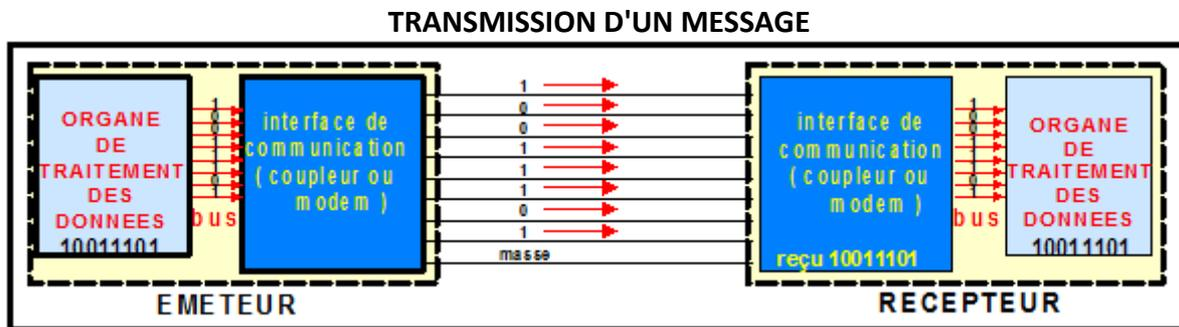
Ce type de liaison est utilisé pour transmettre des données sur de courtes distances (quelques mètres)
