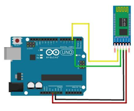
Branchez le module Bluetooth sur la carte Arduino (broche TX sur 2 et broche RX sur 3) et mettez sous tension la carte Arduino en la connectant à l'ordinateur avec le câble USB.
