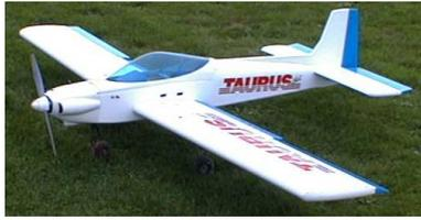
Le moteur thermique étudié est un monocylindre 2 temps de 6 cm<sup>3</sup> de marque WEBRA, il est utilisé pour propulser des modèles réduits d'avion à hélice, fonctionnant avec un mélange de méthanol, nitrométhane et d'huile de synthèse ou de ricin.
