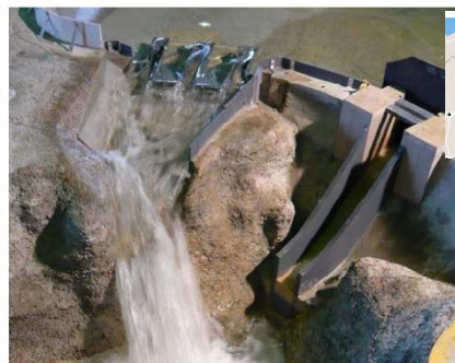
Figure 2 : Evacuateurs de crue du barrage de Goulours : ouvrages sur site et modèle réduit à l'échelle 1/25 e (EDF R&D/LNHE).
