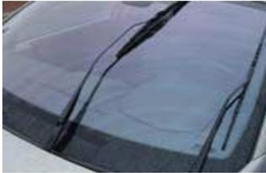
Un dispositif d'essuie-glace est formé d'un moteur électrique entraînant un montage de type bielle/manivelle. Ce dernier assure la transformation du mouvement rotatif du moteur électrique en mouvement alternatif pour les balais.
