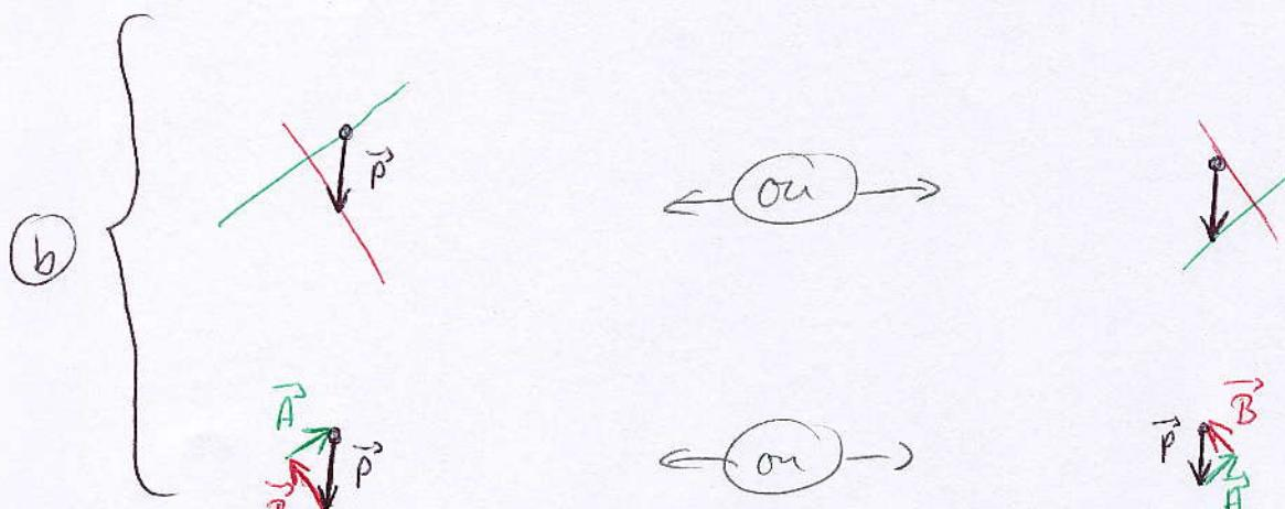
On mesure les vecteurs et on multiplie par l'échelle pour avoir la norme.
