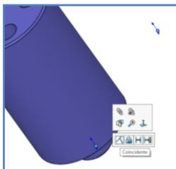
Cliquer sur l'origine de l'assemblage et l'origine de la pièce à fixer et mettre une contrainte de coïncidence.
