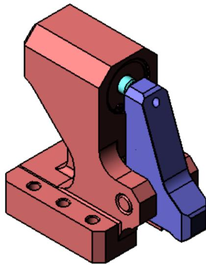
Ce système est destiné à être fixé sur toute table de machine munie de rainures « en T » et d'une source de pression hydraulique.
