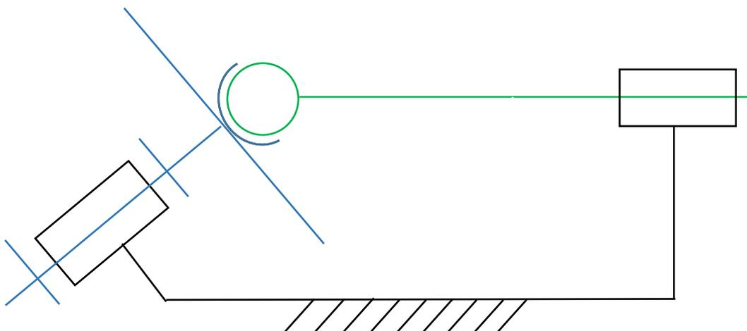
**Question 3.2** - Déterminer la course du piston, connaissant l'angle d'inclinaison ( $40^\circ$ ) du plateau d'entrée et le diamètre ( $\varnothing 63.7 \text{ mm}$ ) sur lequel se trouvent les points de contact piston-plateau.
