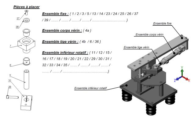
Q13. Nommer les ensembles sur le schéma ci-dessous et indiquer le nom et l'axe de la liaison entre l'ensemble fixe et l'ensemble rotatif.
