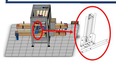
Le pousseur permet de déplacer les produits par paire afin de les positionner sous le système de préhension. Il est fixé sur la butée qui stoppe les produits au bout du tapis de l'encaisseuse.
