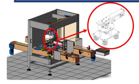
Montée sur le bras de transfert de l'encaisseuse, cette partie rotative permet de saisir des produits en les aspirant et permet de leur faire réaliser une rotation d'un quart de tour afin de les positionner correctement dans les caisses.
