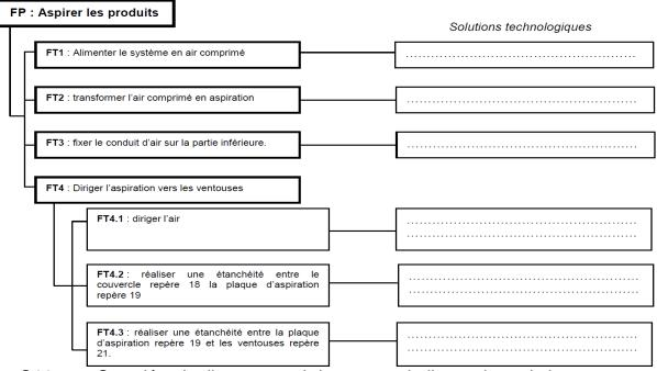
Q11. Compléter le diagramme ci-dessous en indiquant les solutions technologiques (*vérin 4 ; 2 coussinets 8 ; compresseur ; plot 14 et contre-écrou 37*) permettant de réaliser les fonctions.
