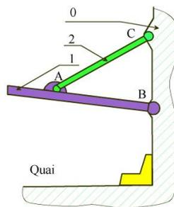
Déterminer l'intensité de la force dans la liaison pivot au point B connaissant le poids du toit et la position de son centre de gravité
