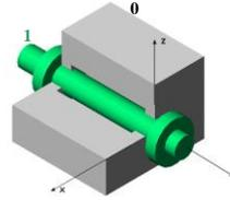
Un solide est en mouvement de rotation autour d'un axe fixe si la trajectoire de chacun de ses points est un cercle centré sur l'axe de rotation.
