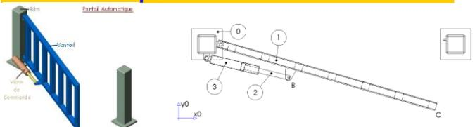
La pièce (2) a un mouvement plan sur plan dans le repère (O, x<sub>0</sub>, y<sub>0</sub>).
