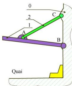
Déterminer l'intensité de la force dans la liaison pivot au point B connaissant le poids du toit et la position de son centre de gravité
