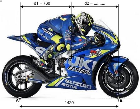
On considère la moto à vitesse constante sur une surface horizontale. Masse de la moto + pilote : 270 kg
