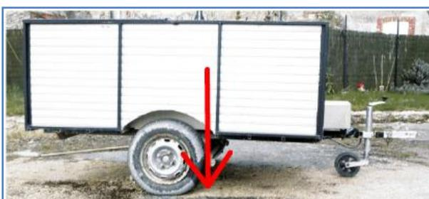
Q1) Tracer le vecteur réaction du sol sous l'essieu principal et sous la roue jockey, sur l'image
