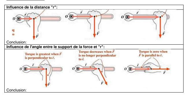
Le moment d'une force par rapport à un point est égal au produit de l'intensité de la force et de la distance d entre le support de la force et le point considéré (d = bras de levier ; d est perpendiculaire au support de la force et passe par le point considéré).
