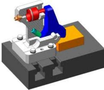
Le système étudié est une bride mécanique permettant de maintenir une pièce pendant un usinage.
