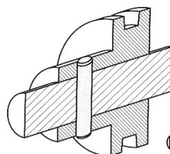
Une solution constructive consiste à intercaler entre l'arbre moteur et l'arbre récepteur une pièce qui supporte le couple à transmettre. Cette pièce est dimensionnée pour se rompre lorsque le couple limite est atteint. Cette pièce, généralement une goupille, est parfois appelée « fusible mécanique ».
