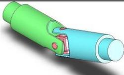
Le cardan simple n'est homocinétique que si les arbres sont alignés. Plus l'angle de brisure entre les deux arbres est grand, plus la vitesse sera saccadée. L'homocinétisme n'est possible qu'avec deux cardans déphasés d'1/4 de tour.
