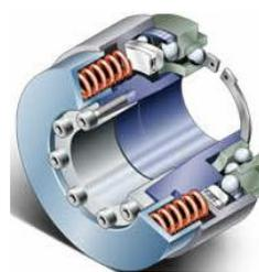
On intercale entre les parties menées et menées des éléments solides (billes, rouleaux, ...) qui assurent la transmission du couple, grâce à la présence de logements. Lors d'une surcharge, ces éléments se trouvent entraînés hors de leur logement. Il y a désaccouplement des deux arbres. Le limiteur doit alors être réarmé manuellement, électriquement, etc, pour transmettre à nouveau.
