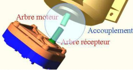
La liaison mécanique permanente entre un arbre moteur et un récepteur peut être assurée par un accouplement. C'est-à-dire un mécanisme qui accepte et compense les défauts géométriques entre les deux arbres.
