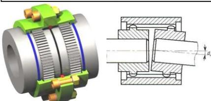
La forme bombée des dentures permet d'accoupler des arbres légèrement désalignés.
