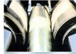
Roulage des filets
