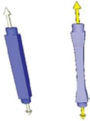
La **traction** provoque un allongement et un rétrécissement pouvant entraîner la rupture du matériau si l'effort augmente.
