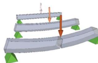
La **flexion** provoque un fléchissement pouvant entraîner la rupture du matériau si l'effort augmente.
