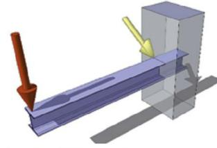
Le **cisaillement** est souvent rencontré quand il y a des porte-à-faux (un balcon, par exemple). Il provoque une fissure pouvant entraîner la rupture du matériau.
