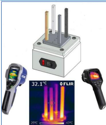
La thermographie infrarouge est une méthode d'essai non destructif basée sur la mesure des températures de surface qui met essentiellement en œuvre les transferts de chaleur par conduction et rayonnement thermiques.
