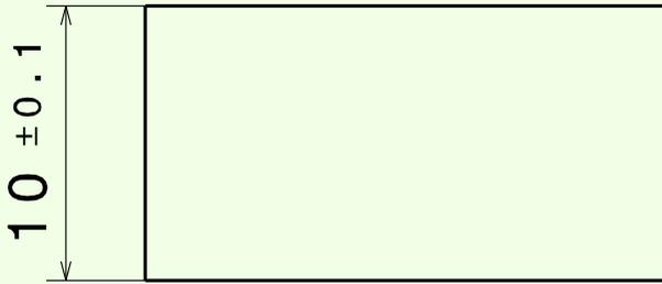
**Taille Linéaire** : limite uniquement les dimensions locales réelles d'un élément mais pas ses écarts de forme (mesure entre deux points).
